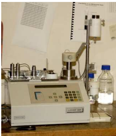
Obr.2: Přístroj pro Superkritickou Fluidní Extrakci. (foto M. Zapadlo)
