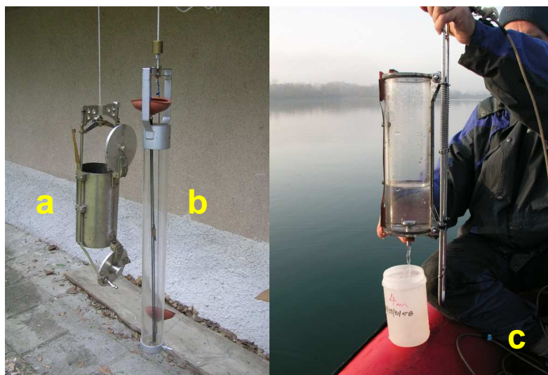
Obr.1: Friedingerův (a) a Van Dornův (b) odběrák. Použití Friedingerova odběráku v terénu (c). (foto E. Tošenovský a P. Hekera)
