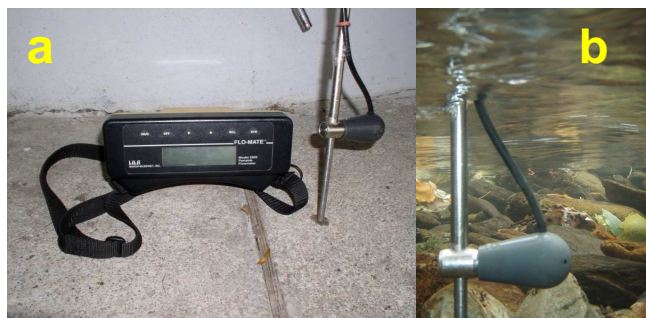
Obr.4: Přístroj na měření rychlosti proudu – flowmetr s elektromagnetickým čidlem (a). Čidlo musí být při měření ponořeno kolmo k proudnici (b). (foto E. Tošenovský a M. Černý)
