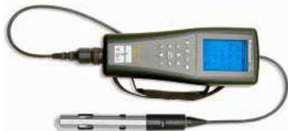
Obr.5: Terénní multimetr YSI ProPlus. Tento přístroj umožňuje různou kombinaci měřených parametrů (teplota, konduktivita, pH, ORP, rozpuštěný kyslík, amoniak, dusičnany, chloridy). (katalog fy. Flow-Group 2009) www.flow-group.com
