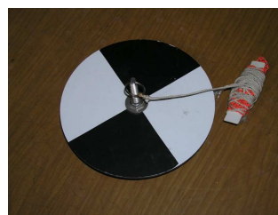
Obr.3: Secchiho disk (foto E. Tošenovský)
